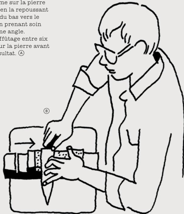
On attaque ensuite la seconde face de la lame en reprenant le geste en miroir, c'est-à-dire en ramenant la lame vers soi, le fil vers l'extérieur. (B)
